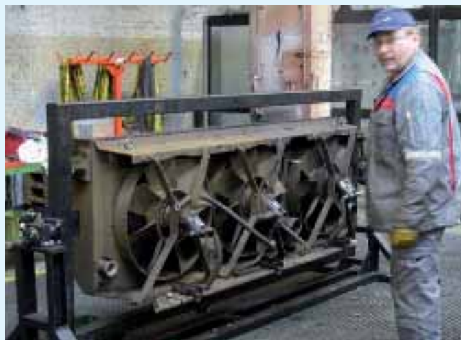
Die Kühlerblöcke können jetzt mit dieser Vorrichtung mühelos gedreht werden
